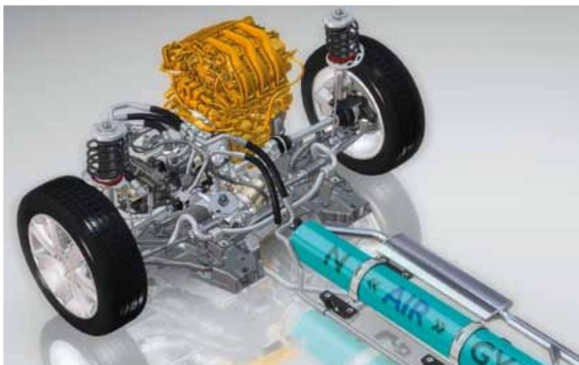
Chaîne de traction HYbrid Air, PSA
